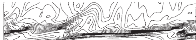
Рис. 2. Вихревая картина течения в пограничном слое при t = 0.85 \text{ s} .
