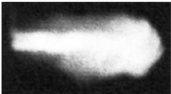
**Рис. 7.** Форма светящейся области, получаемой при относительно низкой напряженности электрического поля в импульсной дуге.
