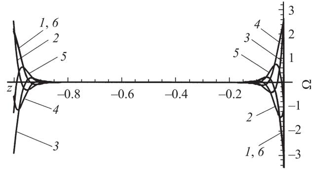
**Рис. 1.** Зависимости от безразмерной глубины амплитудных значений безразмерного ротора поля скоростей течения жидкости, рассчитанные при  $\nu = 0.002$ ,  $k = 3$ ,  $W = 0$ ,  $d = 1$  в различные моменты безразмерного времени, измеренного в долях периода волны: 1 —  $t = 0$ ; 2 —  $T/5$ ; 3 —  $2T/5$ ; 4 —  $3T/5$ ; 5 —  $4T/5$ ; 6 —  $T$ .
