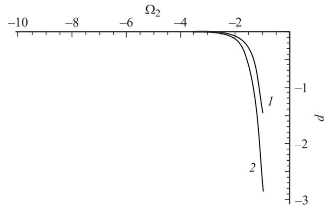
**Рис. 6.** Зависимости амплитуды безразмерного ротора поля скоростей течения жидкости в придонном слое  $\Omega_2$  от безразмерной толщины слоя, построенные при  $\xi_0 = 0.1$ ,  $k = 3$ ,  $\nu = 0.002$ ,  $z = -d$ ,  $t = T/2$ . Кривая 1 соответствует  $W = 1.99$ , 2 — 0.
