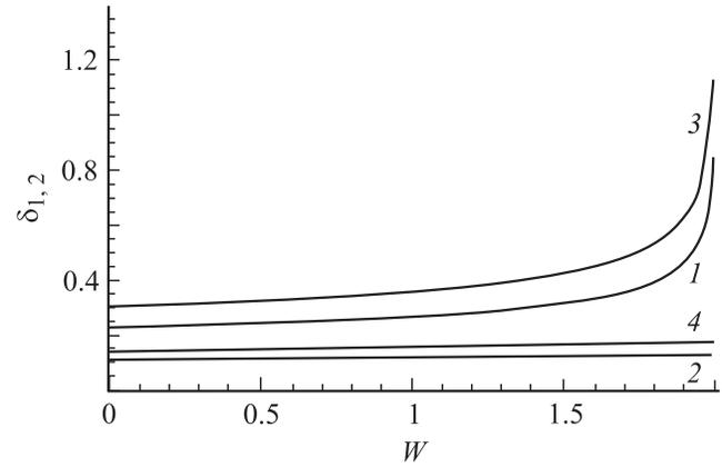
**Рис. 5.** Зависимости безразмерной толщины приповерхностного  $\delta_1$  (кривые 1 и 2) и придонного  $\delta_2$  (кривые 3 и 4) пограничных слоев от безразмерного параметра  $W$  при  $d = 1$ , рассчитанные для различных волновых чисел: кривые 1 и 3 при  $k = 1, 2$  и 4 — при 3.
