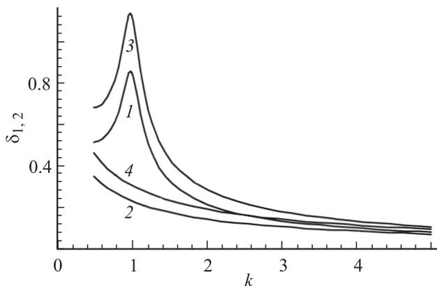
**Рис. 4.** Зависимости безразмерной толщины приповерхностного  $\delta_1$  (кривые 1 и 2) и придонного  $\delta_2$  (кривые 3 и 4) пограничных слоев от безразмерного волнового числа  $k$ , построенные при  $\xi_0 = 0.1$ ,  $\nu = 0.002$ ,  $d = 1$  и различных значениях параметра  $W$ : кривые 1 и 3 рассчитаны при  $W = 1.99$ , 2 и 4 — при  $W = 0$ .
