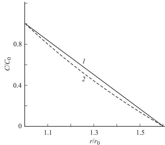
Распределение концентрации атомов водорода в полом цилиндре с учетом термодиффузии и термонапряжений (кривая 1) и без их учета (2).
