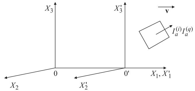
**Рис. 1.**  $X_1, X_2, X_3$  и  $X'_1, X'_2, X'_3$  — соответственно лабораторная система координат и система координат, движущаяся со скоростью  $\mathbf{v}$ ;  $I_a^{(i)}$  и  $I_a^{(q)}$  — потоки массы и тепла через единицу площади.
